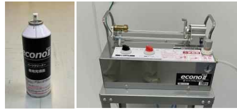
非有機溶剤系のスプレー式洗浄剤及び充填装置（川北工場）
